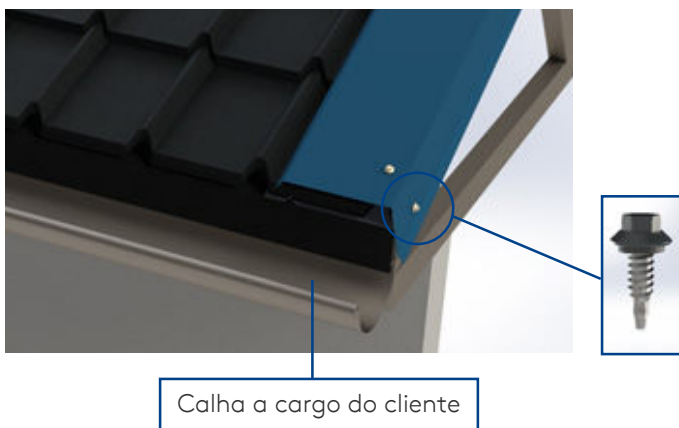
04 - Fixação do acabamento lateral externo:
