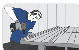
Passo 18 Agora fixe a peça com parafuso de costura a cada 500 mm.
