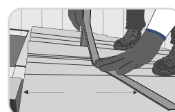
Passo 8 Para o transpasse entre telhas utilize a fita Butilica dupla face.
